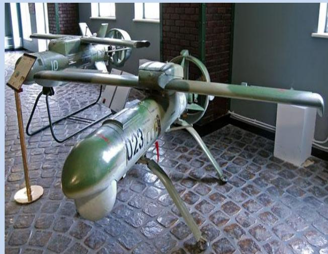
Тепловизионную или телевизионную круглосуточную передачу изображения обеспечивает ДПЛА «Пчела-1Т», которая подаёт информацию в режиме рабочего времени, показывая, таким образом, постоянную картину меняющихся условий. Изначально эта модель использовалась в военно-промышленном комплексе.
